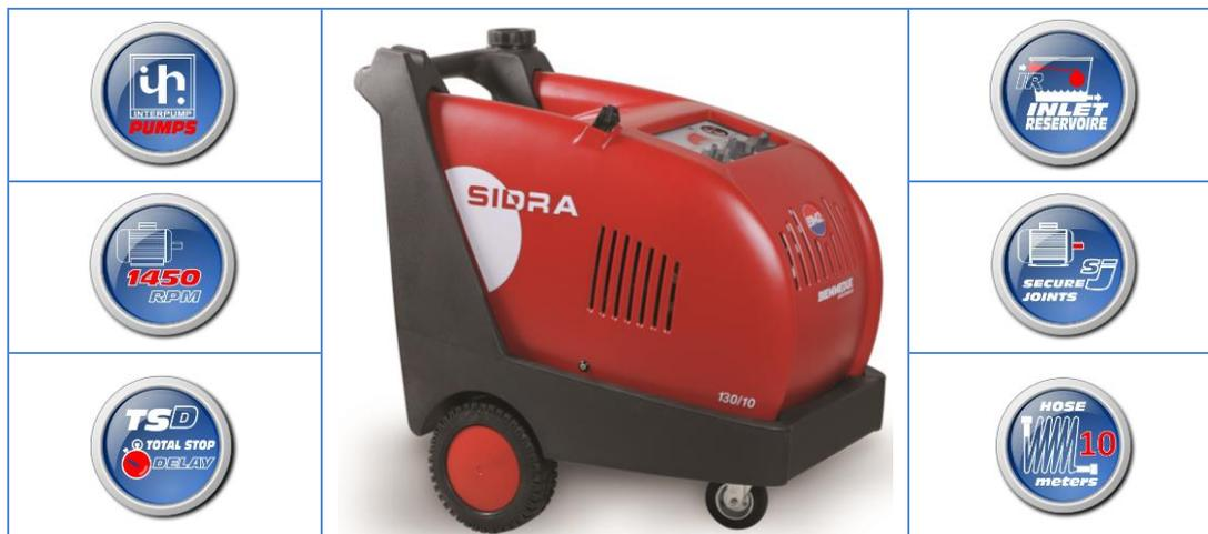
Hidrolimpiadora de agua caliente monofásica fabricada íntegramente con tecnología y componentes italianos de alta calidad. Sólida, robusta y de fácil mantenimiento. Estructura de polipropileno reforzado y chasis-depósito con dos ruedas fijas traseras y una delantera giratoria. Bomba de pistones cerámicos con sistema de bielas y cabezal de latón. Motor de alta eficacia que garantiza un gran rendimiento aun después de muchas horas de trabajo.
